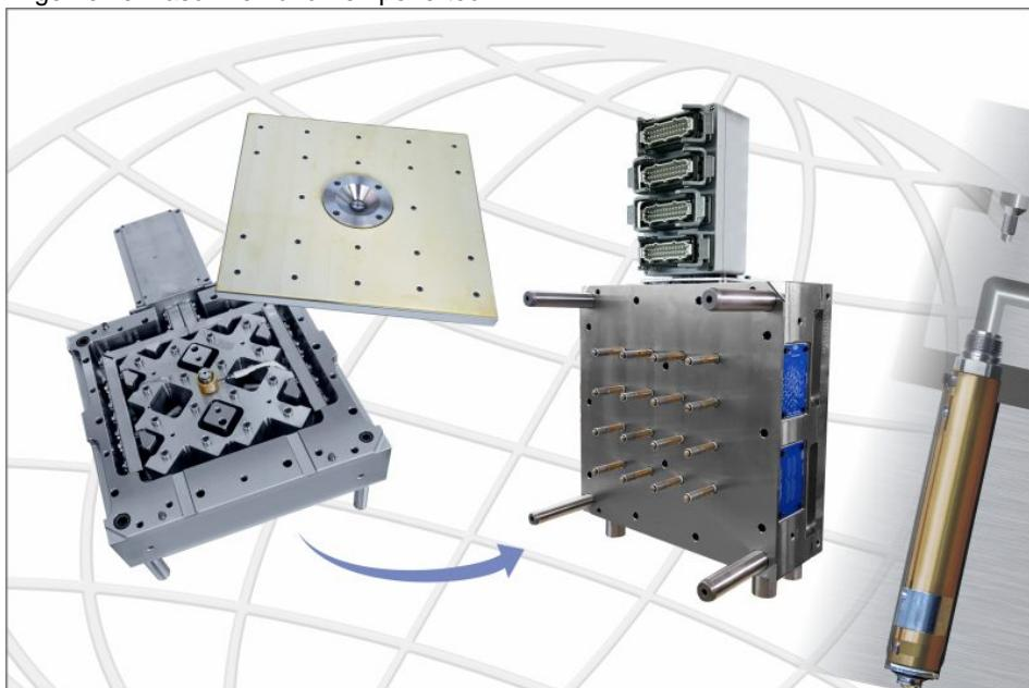
Die neuen »SealFit«-Heiße-Seiten bieten Effizienz beim Werkzeugbau und Spritzguss sowie einen zuverlässigen Betrieb (Bild: Incoe).
