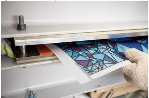
Die maßgeschneiderte Aluminiumheizplatte sorgt für bestmögliche Druckergebnisse (Bild: Busse Heizplattentechnik).
