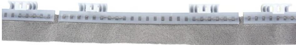
Das Endlosspritzverfahren eignet sich besonders für Anwender, die Produkte mit Vlies oder Gewebe produzieren (Bild: Alhorn).
