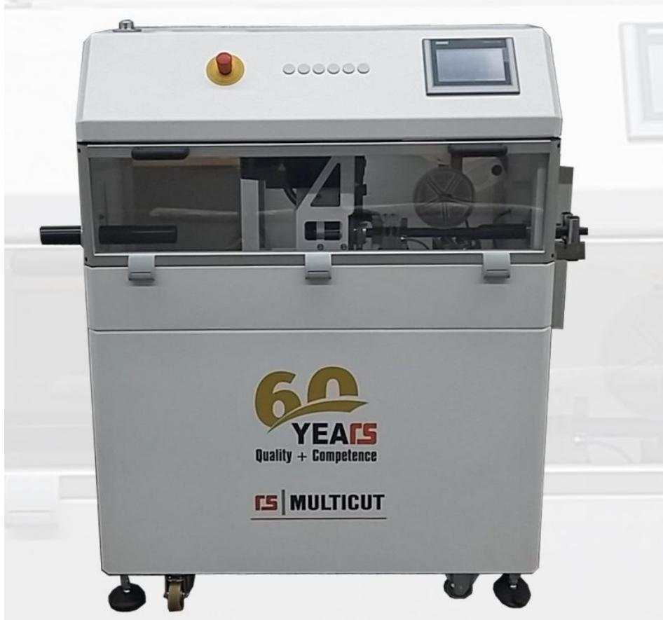
Die neue Orbitalschneidmaschine ist eine Alternative zu Sägen und Guillotinen (Bild: Rolf Schlicht).
