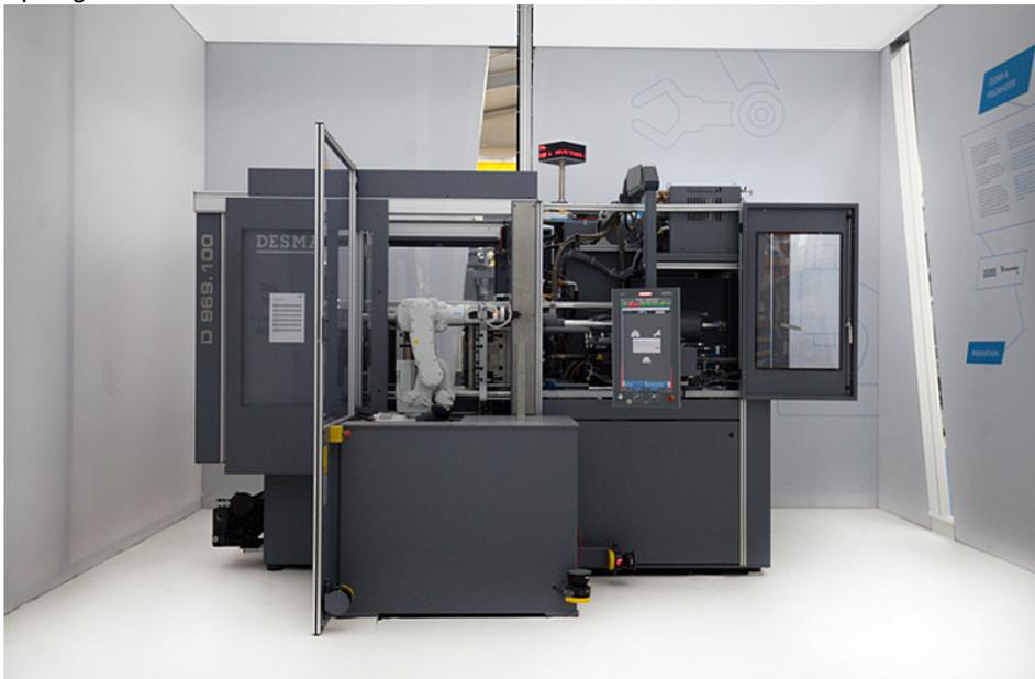
Spritzgießmaschine mit Roboterzelle (Bild: Desma).
