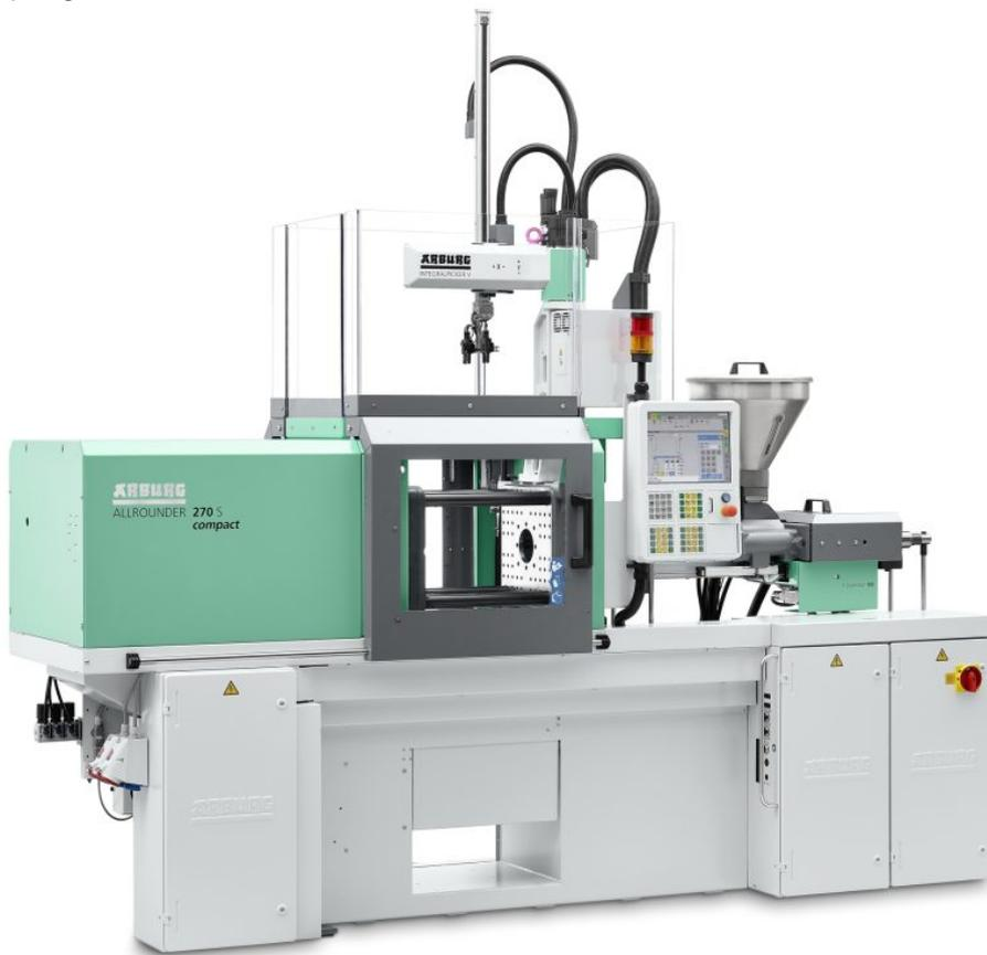
Zu den neuen Optionen für die kompakte Spritzgießmaschine zählen eine Trennebenen-Einrichtung für vertikales Einspritzen oder die Möglichkeit zur Automation mit einem Integralpicker (Bild: Arburg).
