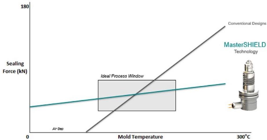
Die verbesserte Dichtcharakteristik bietet eine größere Zuverlässigkeit (Grafik: Mold-Masters).
