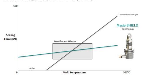
Die verbesserte Dichtcharakteristik bietet eine größere Zuverlässigkeit (Grafik: Mold-Masters).
