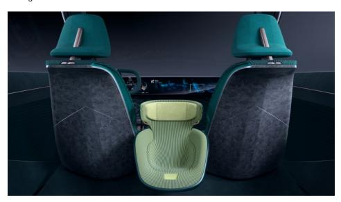
Ein thermoplastischer Verbundwerkstoff spart Gewicht bei der Rückenlehne (Bild: Covestro).
