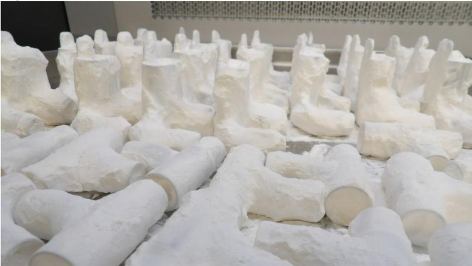
3D-gedruckte Ventile für Notfallbeatmungsmasken. Bild: Protolabs
