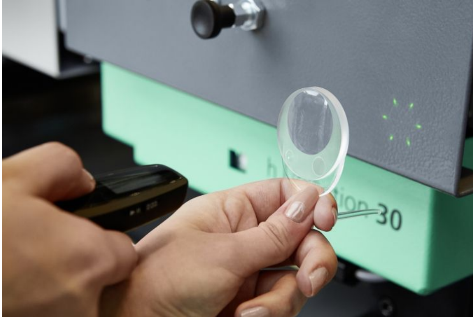
Ein hydraulischer »Allrounder 170 S« produziert in rund 50 Sekunden Zykluszeit strukturierte Optikplatten. Bild: Arburg
