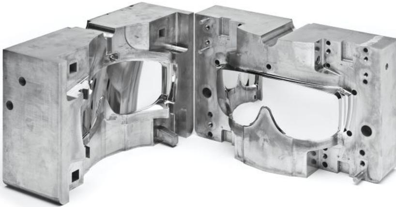
Beide Hälften eines behandelten Form-einsatzes, die Funktionsfläche wurde mit dem neuen Verfahren beschichtet und poliert. Bild: H-O-T
