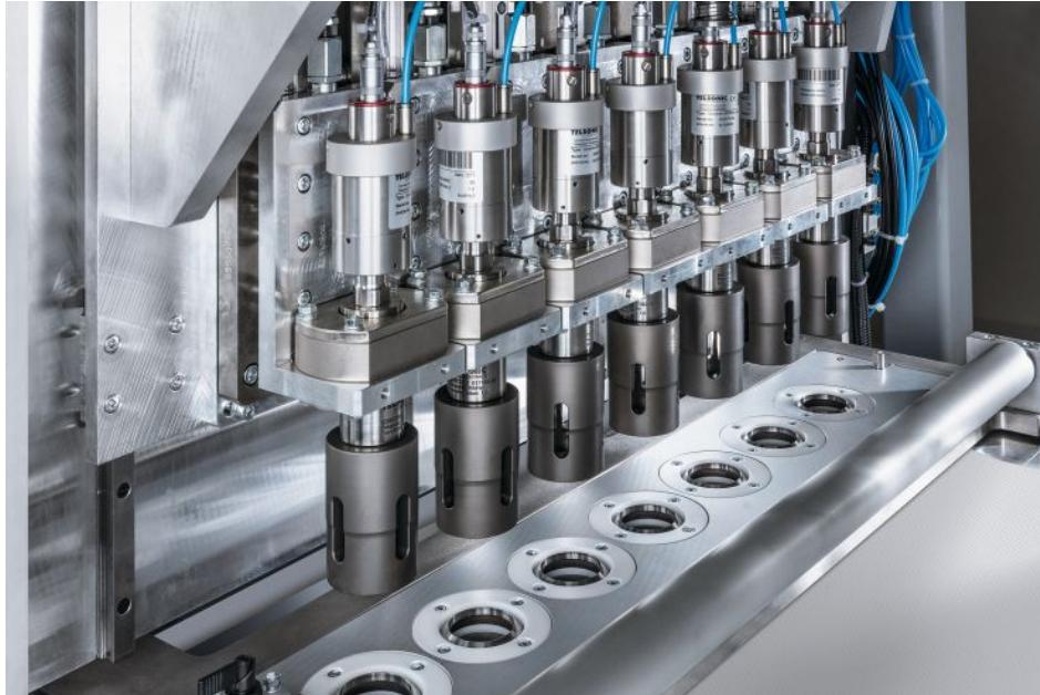
Fürs passgenaue Zuschneiden der kleinen Filter und ihre Befestigung an der Kapsel sorgen Ultraschallschneid- und -schweißsysteme von Telsonic. Bild: Telsonic
