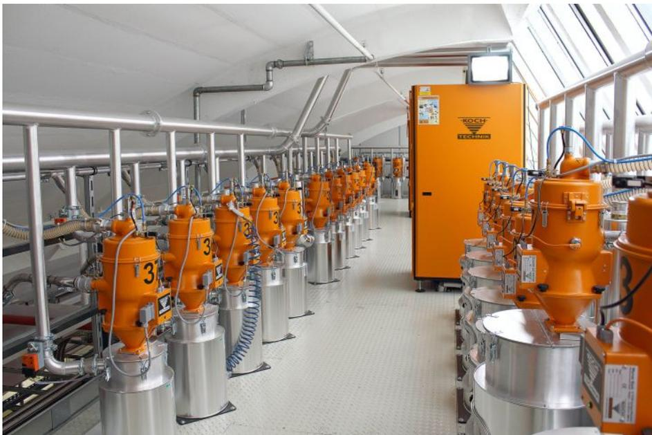
Granulatrocknung: Die zentrale Anlage mit insgesamt drei Trockenlufttrocknern, die 38 Trocknungsbehälter mit einer Trockenluftmenge von insgesamt bis zu 1600 m<sup>3</sup>/h versorgen. Bild: Koch-Technik
