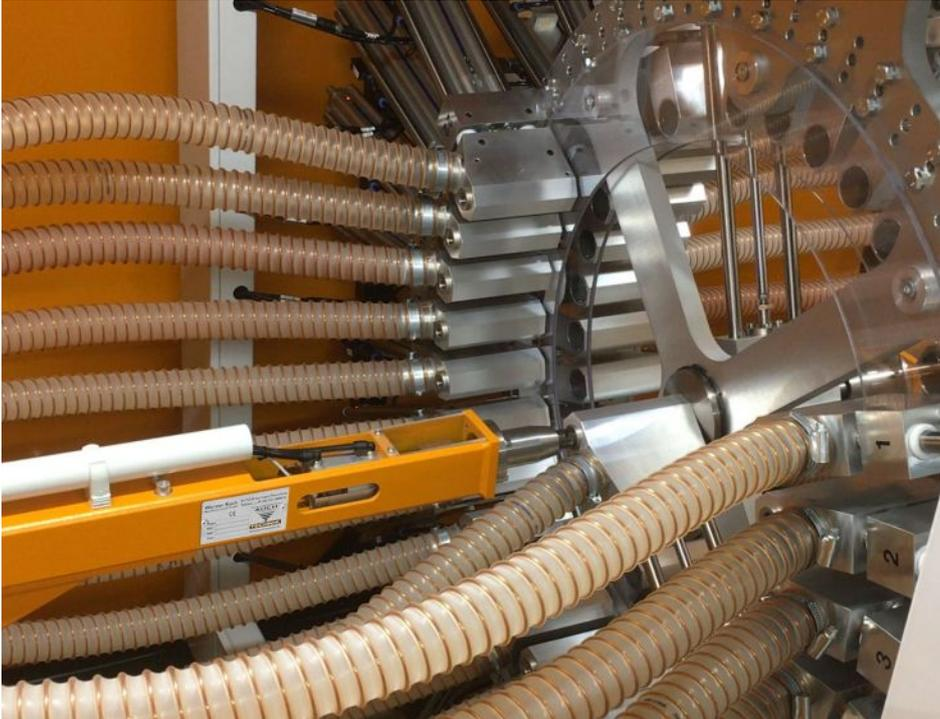
Zur Materialverteilung fahren die pneumatischen Schieber des Navigators die gewünschte Material- und die Maschinenleitung in der Mitte zusammen. Bild: Koch-Technik
