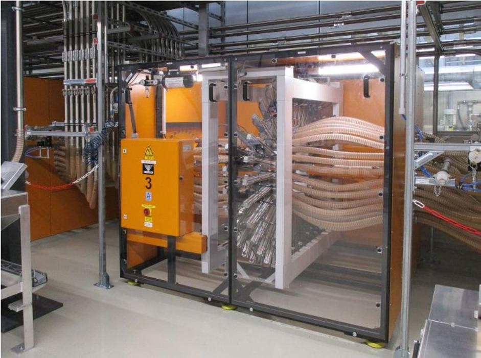
Materialverteilung: Über die »Navigatoren« kann jede Bedarfsstelle in der Spritzerei mit jedem vorbereiteten Material versorgt werden. Bild: Koch-Technik
