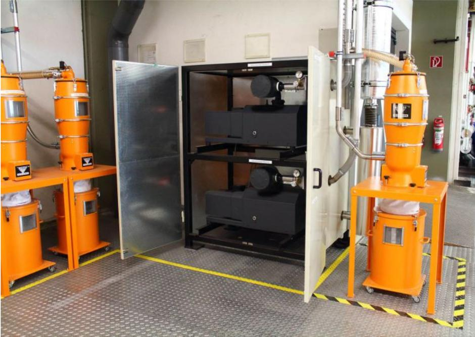
Die Vakuumpumpen arbeiten frequenzgeregelt, was den Energieverbrauch senkt und die materialführenden Leitungen vor Verschleiß schützt. Bild: Koch-Technik
