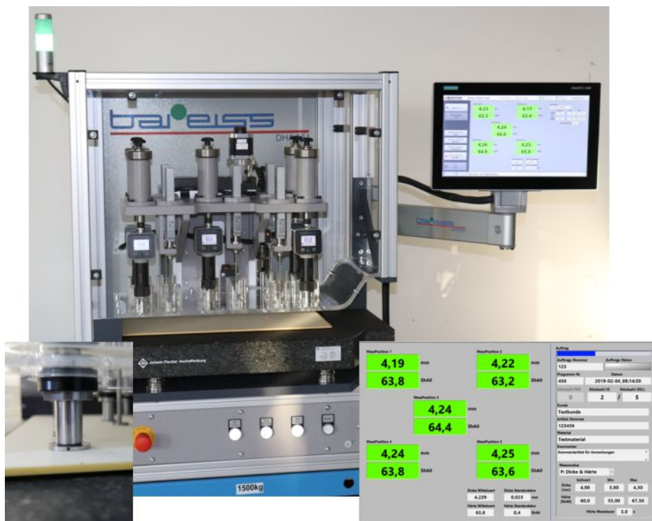
Der neue Dicke-Härte-Automat »DHA 551« von Bareiss bietet bis zu 90 Prozent Zeitersparnis gegenüber der herkömmlichen Messung. Bild: Bareiss
