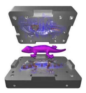
Die Temperierkanäle und Kupferstifte werden gezielt eingebracht, um die Viskosität der Kunststoffschmelze zu optimieren. Bild: Contura MTC
