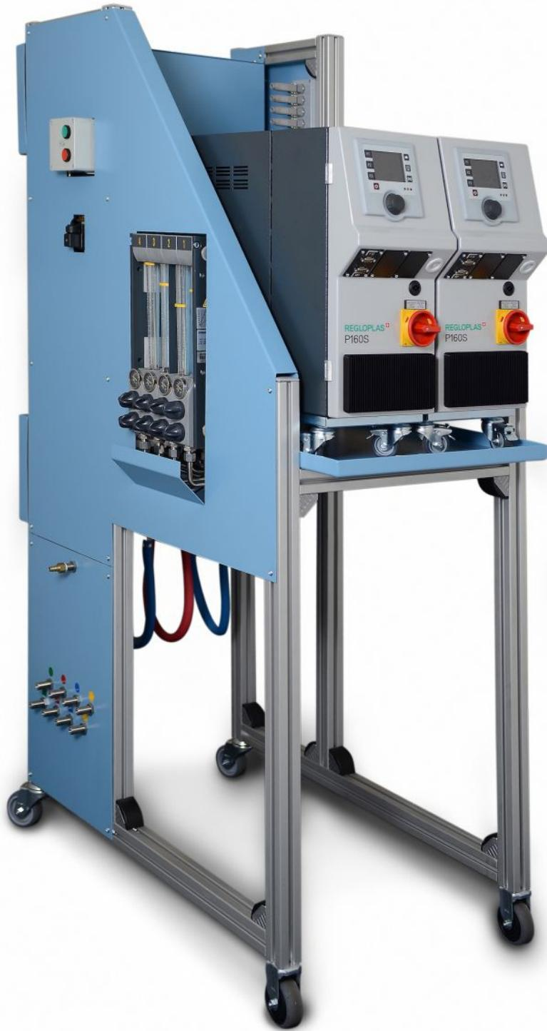
Mit der Dockingstation werden Rüstzeitverkürzungen von bis zu 50 Prozent beim Prozessschritt Werkzeugreinigen erreicht. Bild: Weiss
