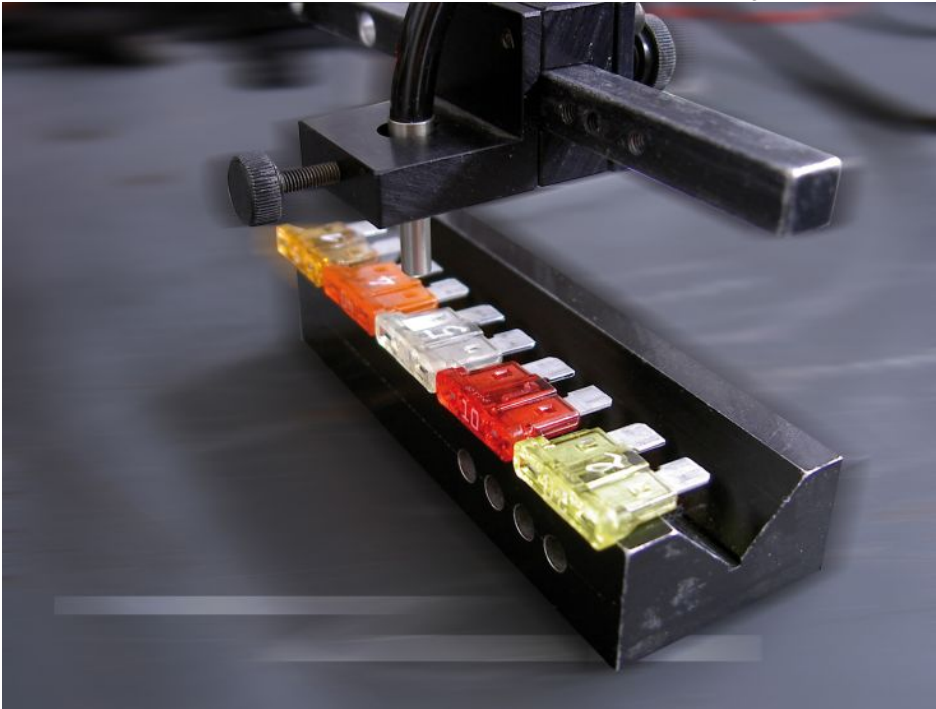
Die Sensoren der Reihe »Colorsensor CFO« sind zur Erkennung minimaler Farbabweichungen konzipiert. Bild: Micro-Epsilon
