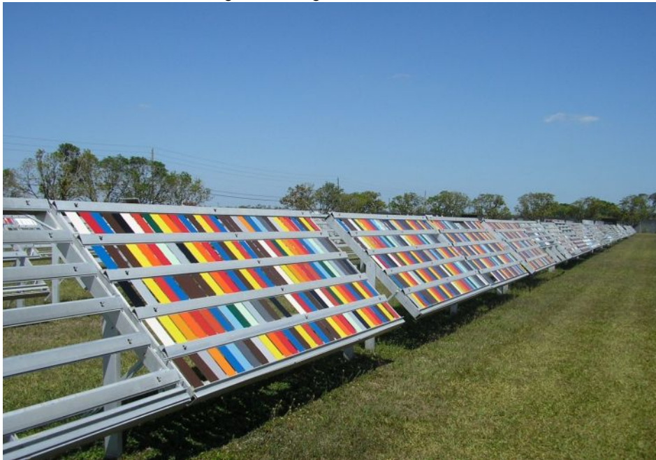
Beispiel für eine Freibewitterung in Florida. Bild: Atlas Material Testing
