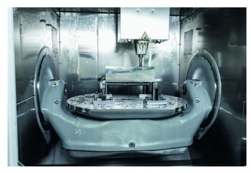
Der Arbeitsraum des Hermle-Bearbeitungszentrums »C 60 U« für schwere Werkstücke. Bild: Hermle
