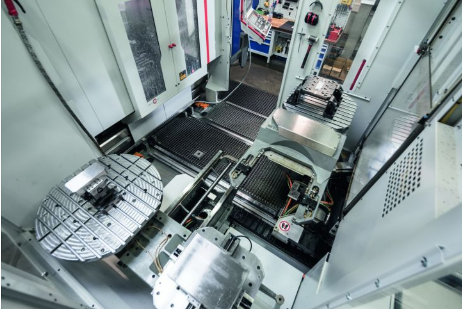
Palettenwechselsystem des Bearbeitungszentrums »C 42 UP« für die Komplettfertigung von Formplatten, Formaufbauten und Aktivteilen aus dem Werkzeug- und Maschinenbau. Bild: Hermle
