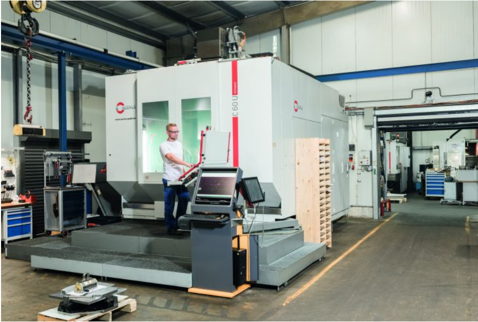
Das 5-Achsen-CNC-Hochleistungsbearbeitungszentrum bei Marks in Eisenberg. Bild: Hermle
