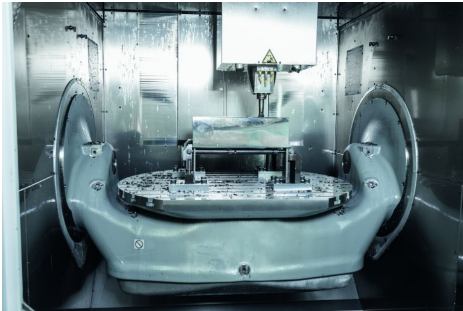
Der Arbeitsraum des Hermle-Bearbeitungszentrums »C 60 U« für schwere Werkstücke. Bild: Hermle
