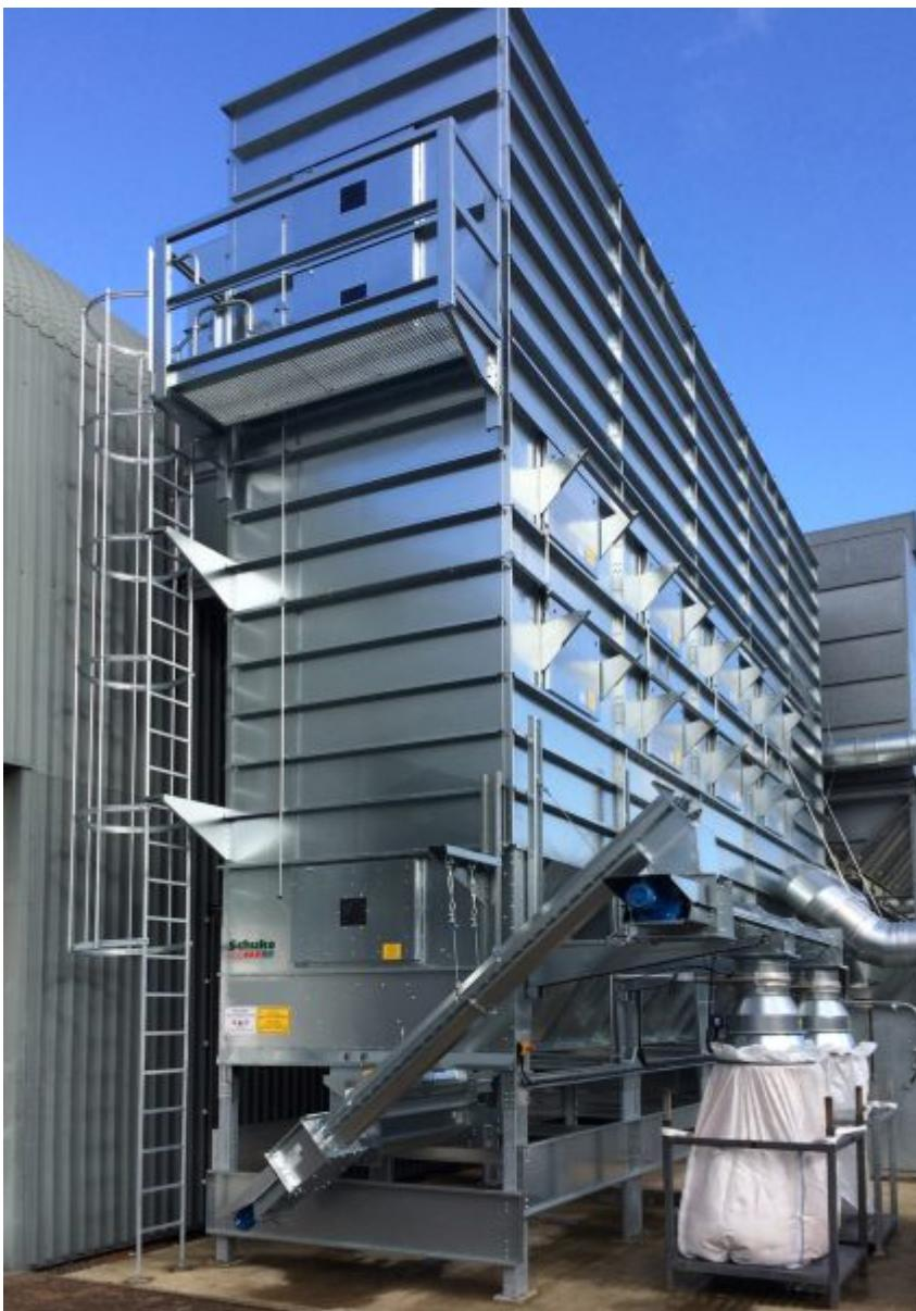
Die Absaug- und Filteranlage Typ »Validus« von Schuko lässt sich als Bestandteil energiesparender Absaugsysteme in vielen Branchen nutzen.
