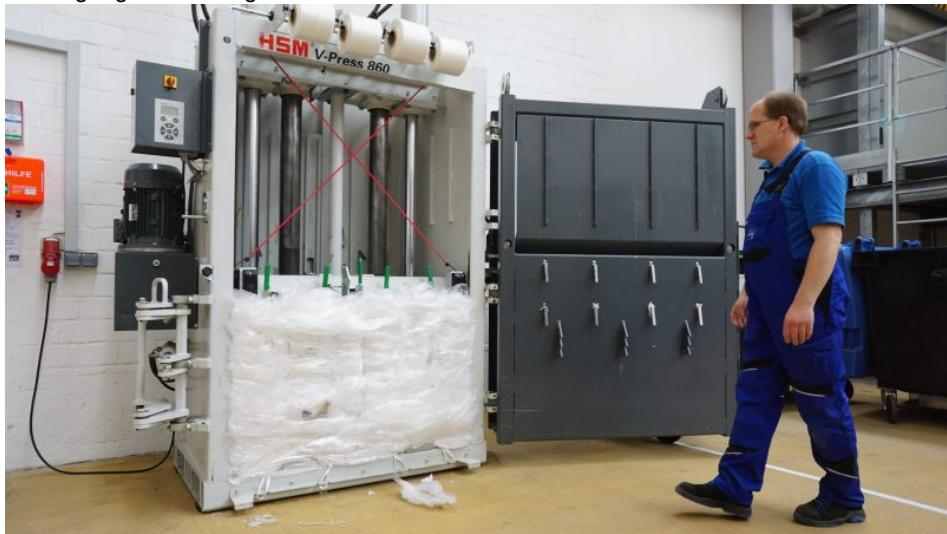
Die Ballenpresse von HSM erzeugt 400 kg schwere Ballen aus PE-Folien auf kleiner Standfläche.
