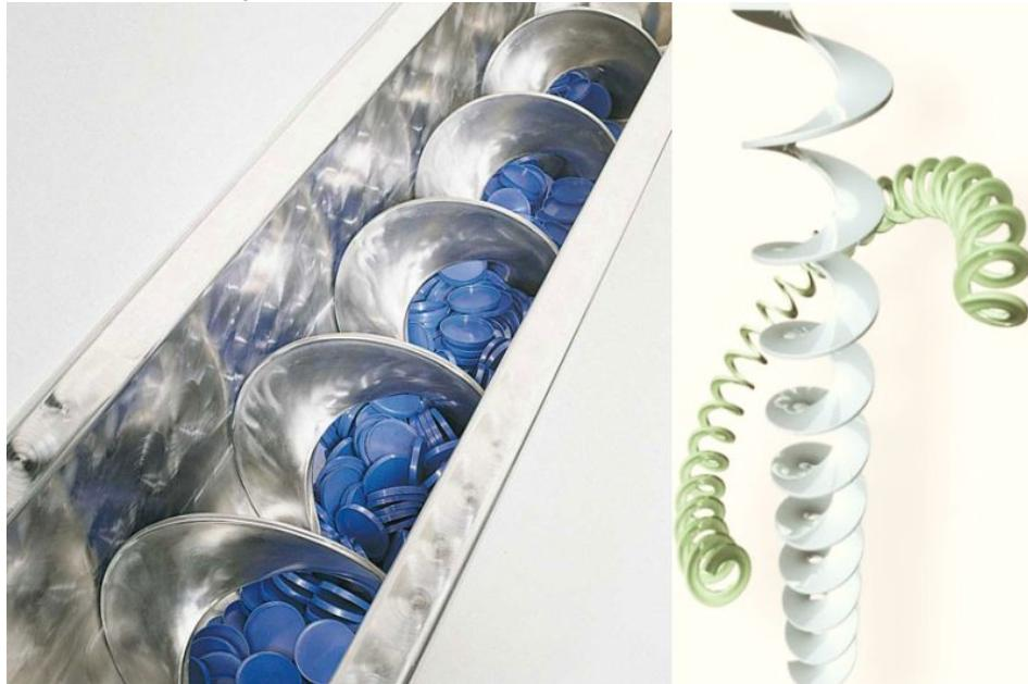
Achsenlose Förderspiralen in biegsamer oder starrer Ausfertigung von Wildfellner fördern Granulat und fertige Teile.
