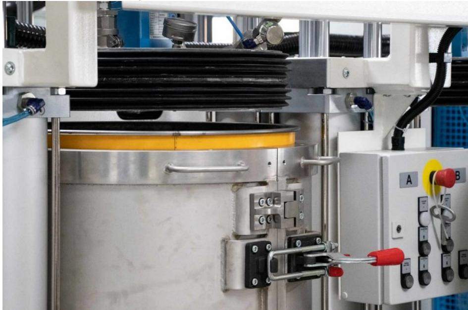
Die 3. Option für einen Fasswechsel arbeitet mit einem Vakuumspannfass (»Tava 200 D«) von Tartler, das wie eine Vakuumkammer funktioniert.
