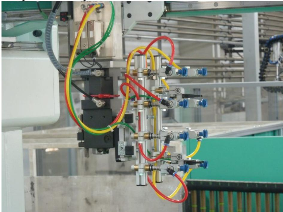
Franke Kunststofftechnik setzt zum raschen Entformen von Spritzgussteilen auf einen 8-fach-Greifer mit »Thermalon«-Vakuumsaugern von Fipa.
