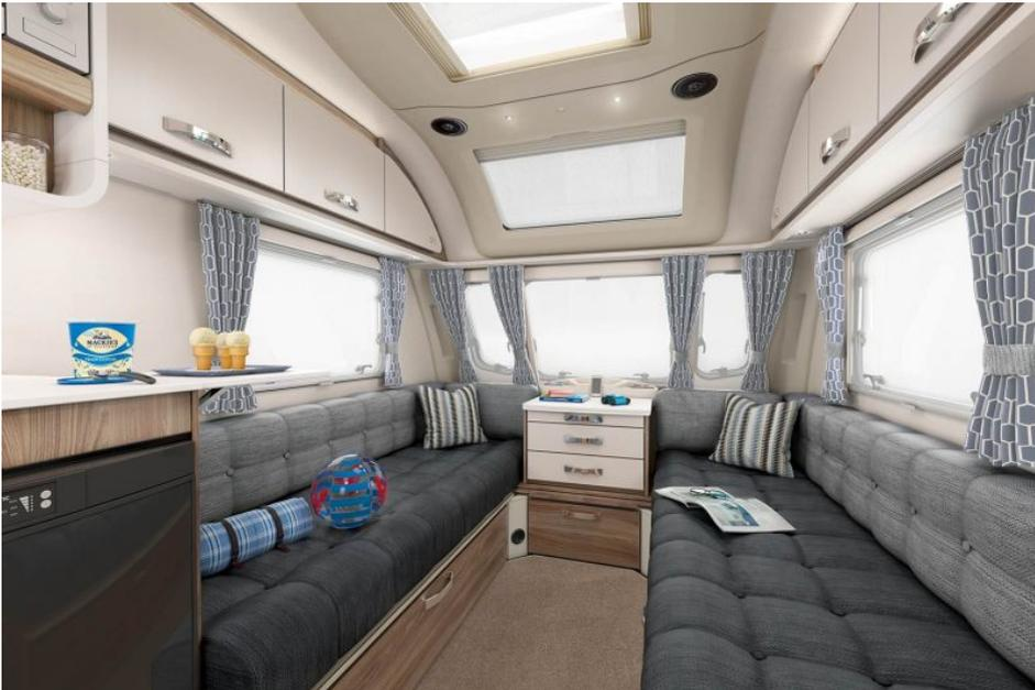
Innenverkleidung eines Caravans mit »Lamilux LamiGraph« von Lamilux Composites. Der faserverstärkte Kunststoff kann bei gleicher Festigkeit dünner ausgelegt werden.
