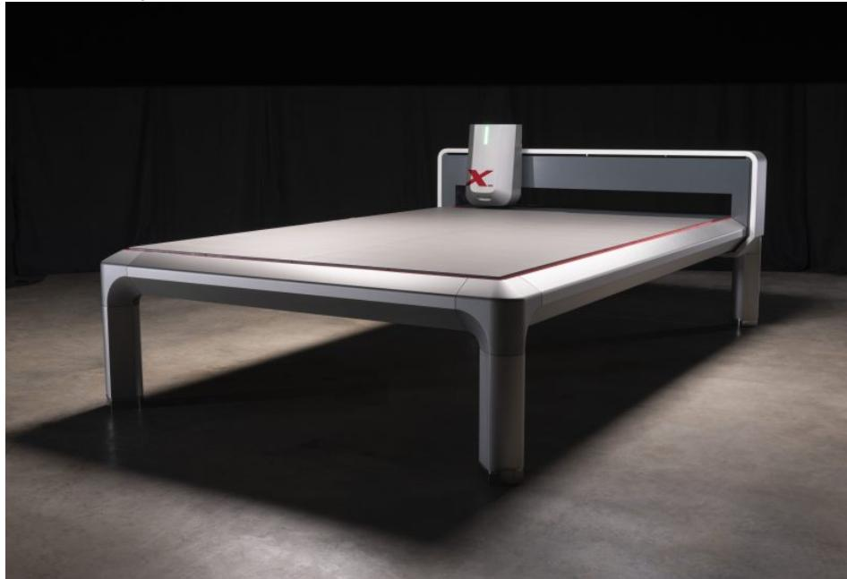
Die CNC-Fräsmaschine »X« von vhf zur Plattenbearbeitung vereint Präzision, Antriebskraft sowie Stabilität und bietet eine hohe Steifigkeit.
