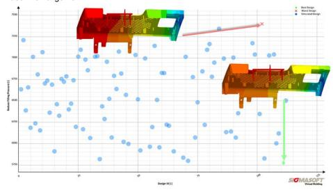
Das Autonomous Optimization in »Sigmasoft Virtual Molding« von Sigma erlaubt es, eine Vielzahl an Design-Iterationen virtuell zu durchlaufen.
