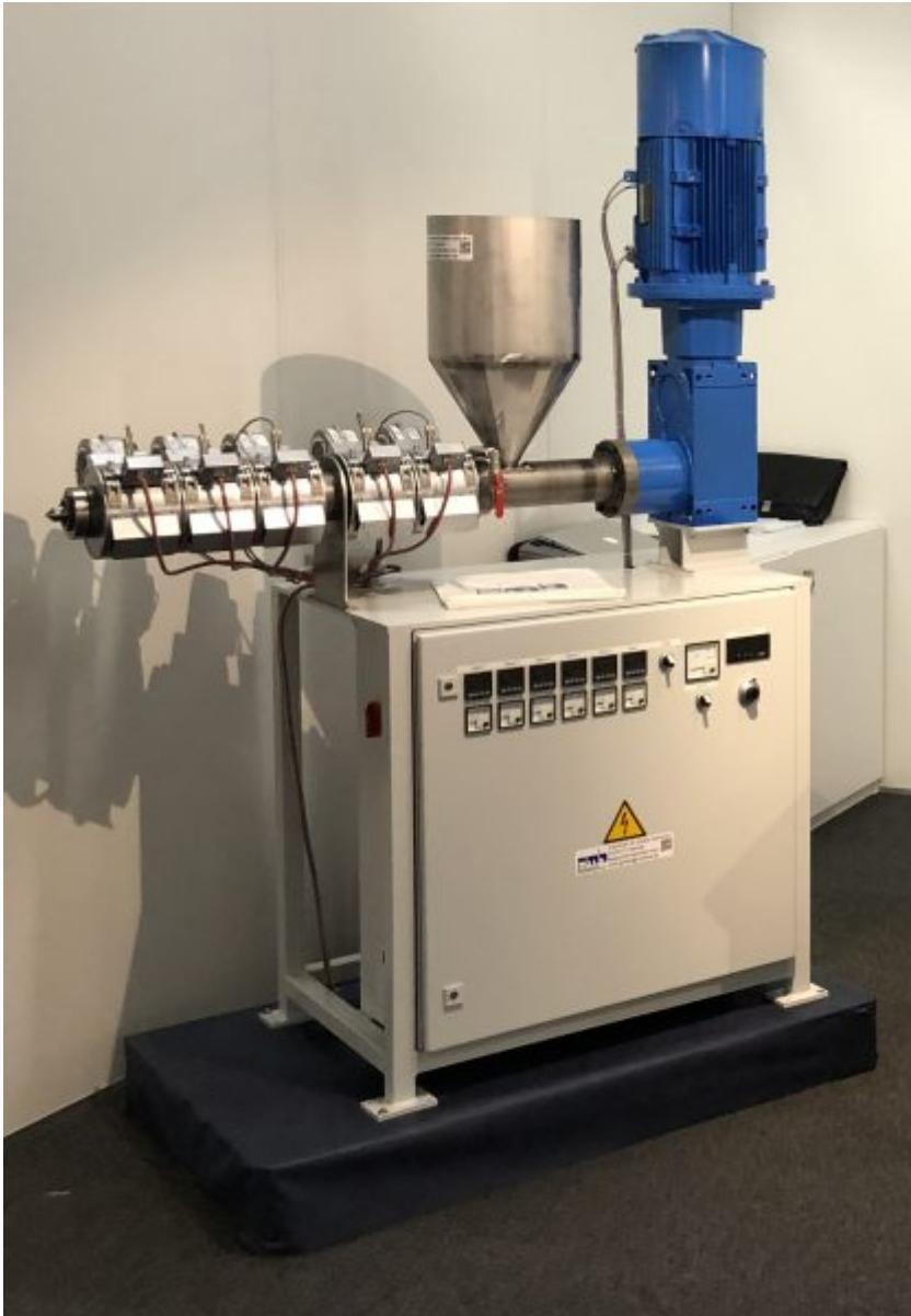
Die Extruder von pmh sind für den 24-Stunden-Einsatz konzipiert und auch für Labor und Forschung geeignet.
