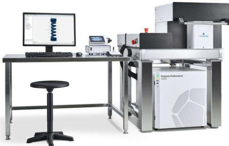
Der 3D-Drucker »Photonic Professional GT2« von Nanoscribe ermöglicht die Herstellung größerer Strukturen mit hoher Präzision in kurzer Zeit.
