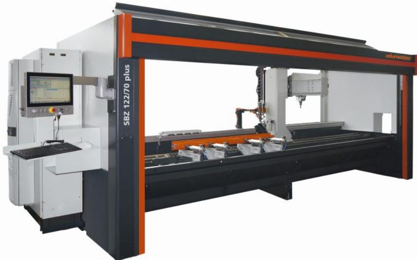
Die »SBZ 122/70 plus« von elumatec ist geeignet für die wirtschaftliche Bearbeitung von Aluminium-, Kunststoff- und Stahlprofilen.
