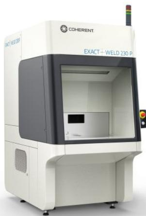
Bauteile aus Polymerwerkstoffen schweißt »Exactweld 230 P« von Coherent mit hohem Durchsatz.
