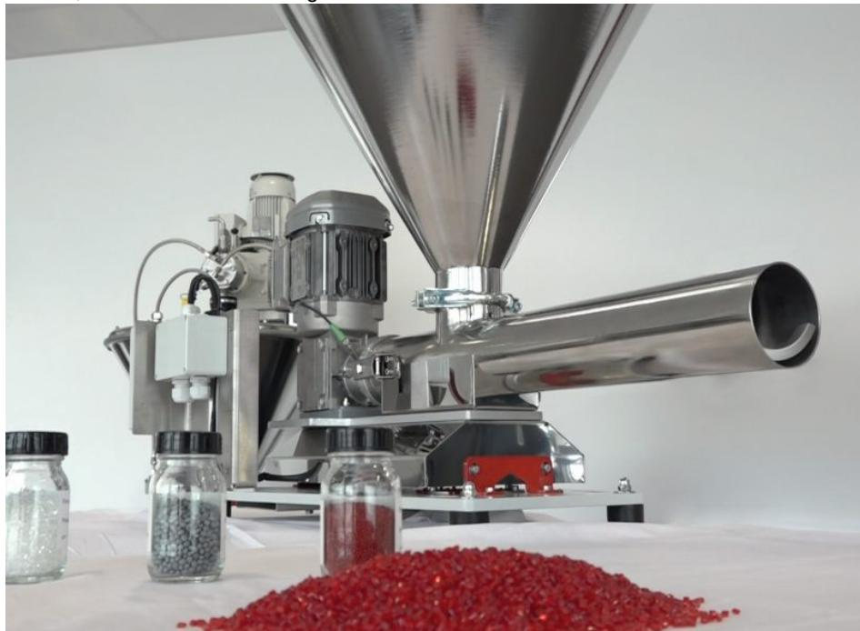
Die neue Dosiererlinie der »DS«-Reihe für Granulate von Brabender Technologie kommt in zwei Versionen und vier Größen auf den Markt.
