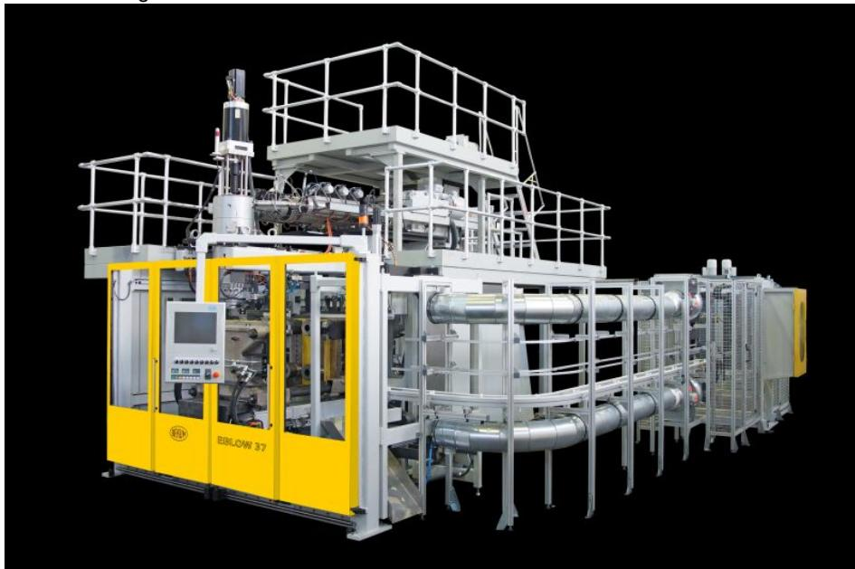
Gegenüber einer rein hydraulischen Lösung ermöglicht die »Eblow 37« von Bekum Maschinenfabriken eine Produktionssteigerung von bis zu 15 %.
