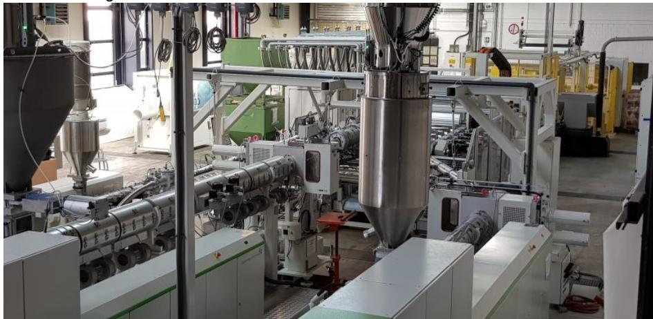
Die Extrusionslinie von Battenfeld-Cincinnati erreicht eine maximale Ausstoßleistung von 1900 kg/h bei PP bzw. PS und rund 1200 kg/h für PET.
