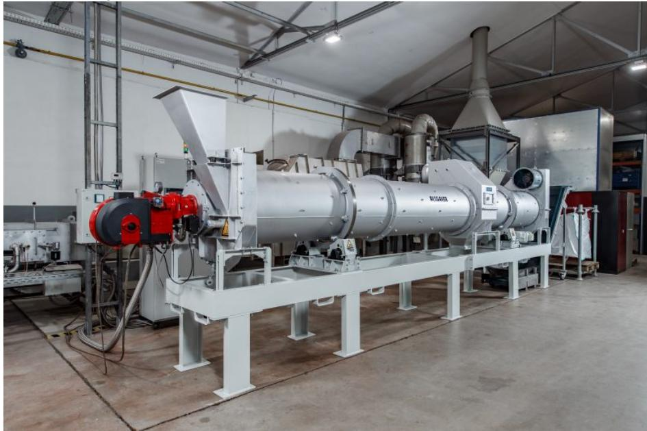
Der neue Trommeltrockner/-kühler »TK-D« von Allgaier Werke ermöglicht kombiniertes Trocknen und Kühlen auf besonders niedrige Temperaturen.
