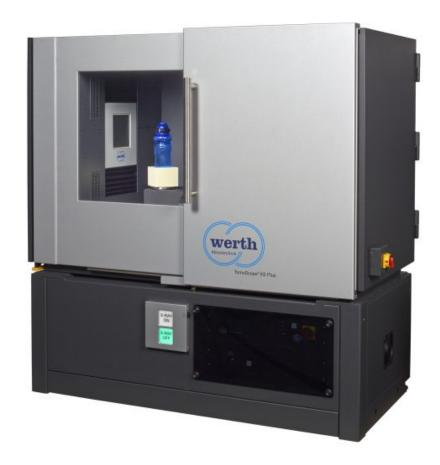
Das Koordinatenmessgerät »TomoScope XS Plus« mit Computertomografie von Werth hat einen großen Messbereich bei kleinem Flächenbedarf.
