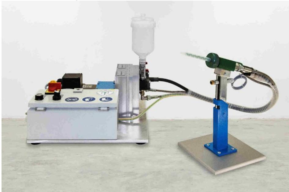
Mit dem Misch- und Dosiersystem »MDM 4« zeigt Tartler ein Tischgerät, mit dem sich flüssige, niederviskose Medien dosieren und mischen lassen.
