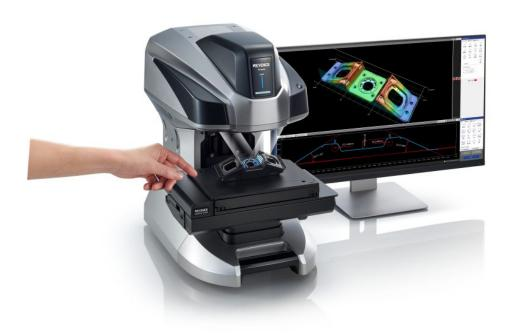
Das 3D-Profilometer »VR-5000« von Keyence verfügt über neue Funktionen wie die automatische Breiten- und Höhenerkennung eines Messobjekts.
