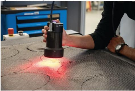
Das »Apodius «-Vision-System 2D von Hexagon ist eine optische Messlösung für die schnelle und präzise Prüfung der Faserorientierung.
