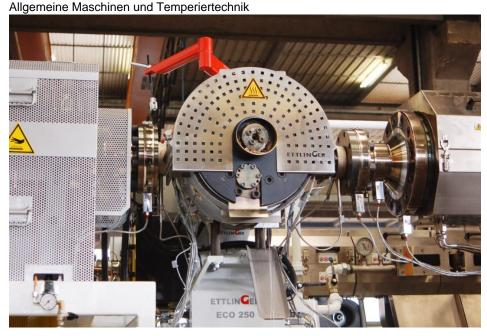
Mit einer Filterfeinheit von 60  $\mu$ m erleichtern die »Eco«-Schmelzefilter von Ettlinger das Aufbereiten und Wiederverwenden von Rezyklaten.
