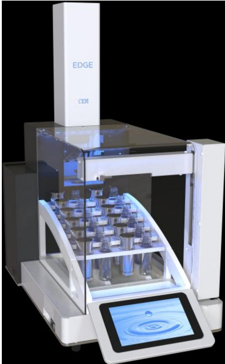
Das »Edge«-Extraktionssystem von CEM ist für die schnelle und automatisierte Lösemittlextraktion von Proben entwickelt worden.
