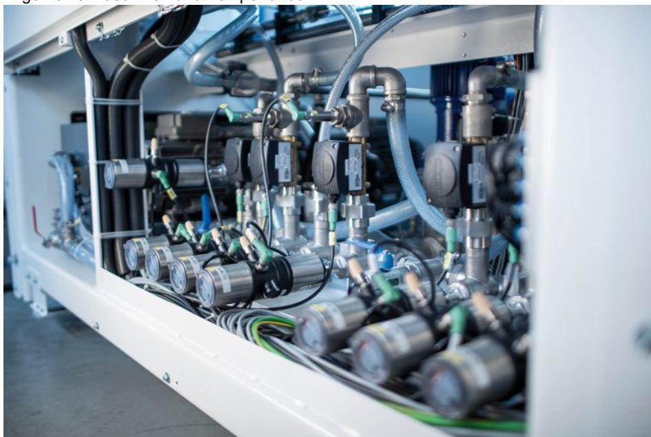
Die modulare Plattform von Bürkert für individuelle Lösungen in Metall- und Kunststoffbearbeitung: Prozesstemperaturen zuverlässig regeln.
