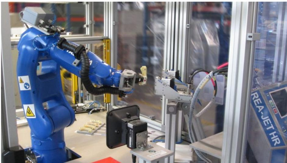
Ein Knickarm-Roboter positioniert die Spannschiene nach der Montage vor einem Zweifarben-Inkjet-Markiersystem. Bild: Weiss
