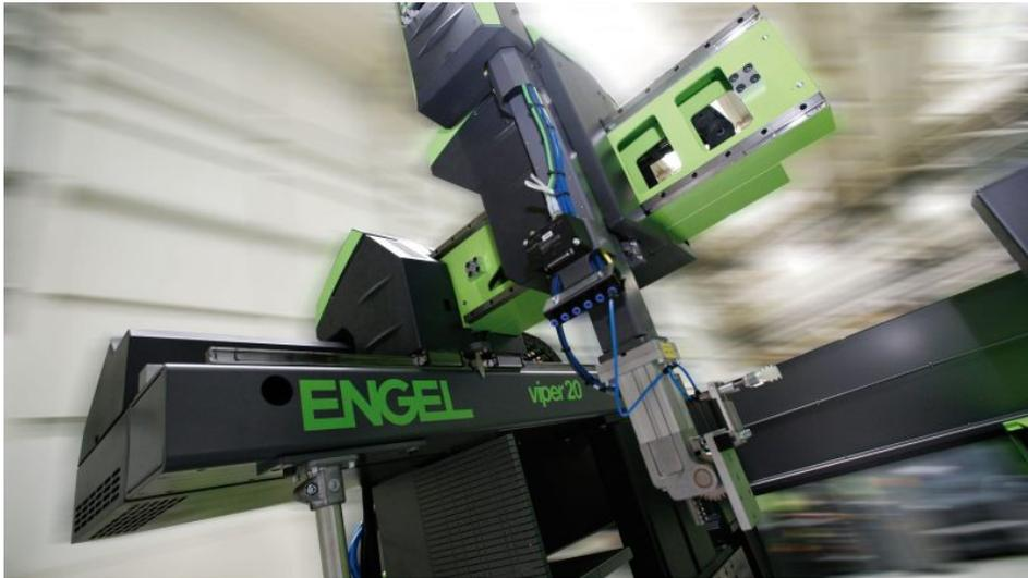
Die »viper«-Linearroboter werden im Einsatz noch flexibler. Bild: Engel
