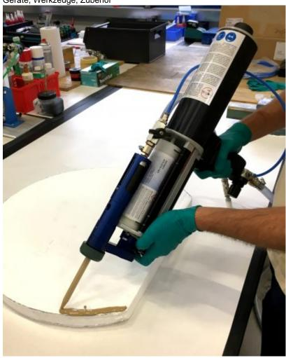
Tartler gehört zu den führenden Herstellern von Mehr-Komponenten-Systemen zum Dosieren und Mischen von Epoxydharzen, Polyurethanen und Silikonharzen. Das Unternehmen stattet unter anderem Windkraft-Anlagenbauer sowie Hersteller im
