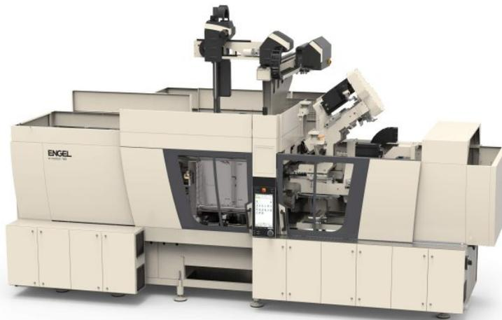
Auf der K 2019 produziert eine vollelektrische Spritzgießmaschine in Reinraumausführung Gehäuseteile. Bild: Engel
