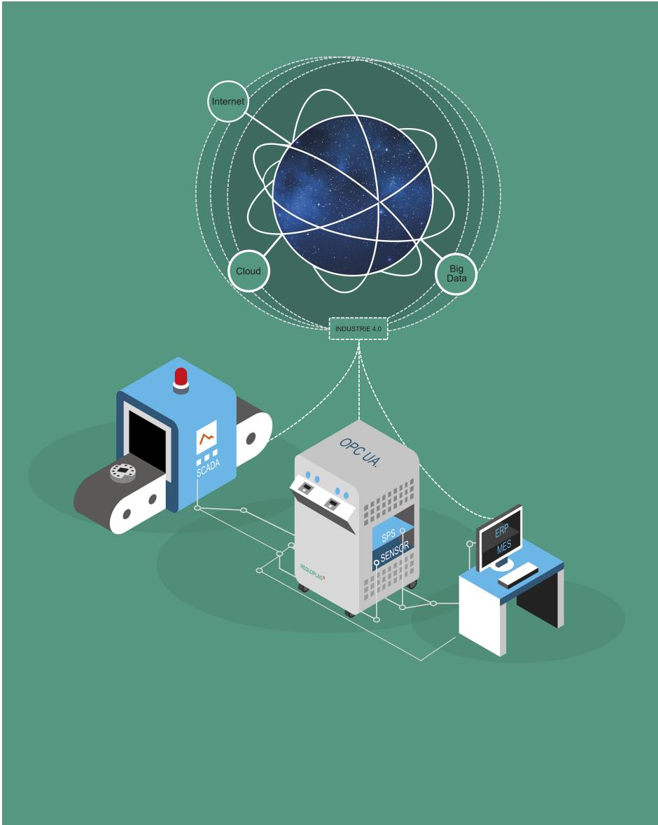
Über OPC UA lassen sich die Temperiergeräte in übergeordnete IT-Systeme einbinden.
