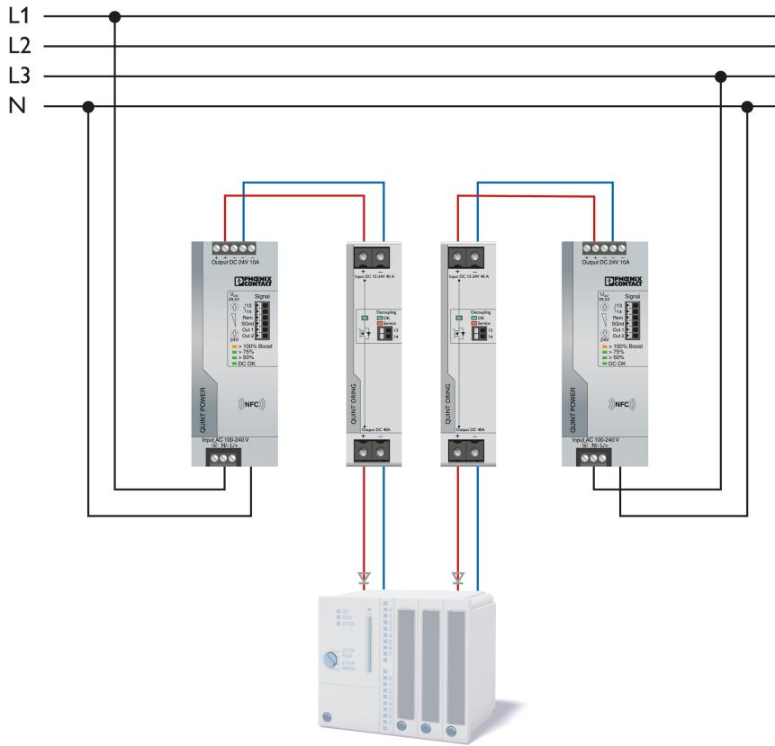
Die neue Generation der Redundanzmodule »Quint S-Oring« von Phoenix Contact steigert im Zusammenspiel mit den neuen »Quint Power«-Stromversorgungen nochmals die ohnehin schon hohe Verfügbarkeit. Die »Quint-S-Oring«-Module wurden für Anwender entwickelt, die besonders hohe Anforderungen an die Verfügbarkeit der Versorgungsspannung stellen. Durch die konsequente Trennung der Strompfade und damit auch die Trennung der verschiedenen Potenziale bis zur Last werden auch bei
