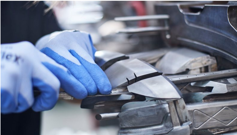
Instandsetzung der Schieber eines Spritzgusswerkzeugs (Bild: Hofmann).
