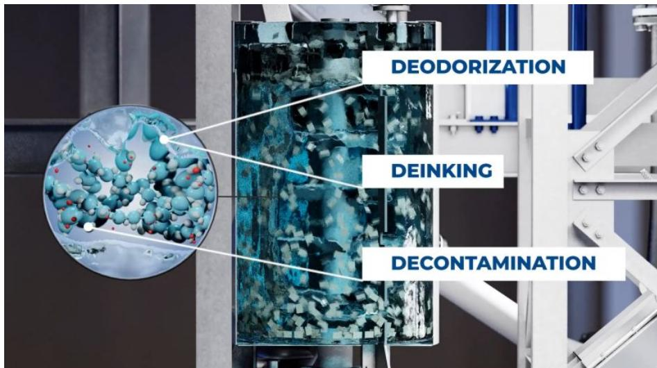
Mithilfe eines lösemittelbasierten Extraktionsprozesses werden Polymerketten von Verunreinigungen befreit (Bild: Lindner).
